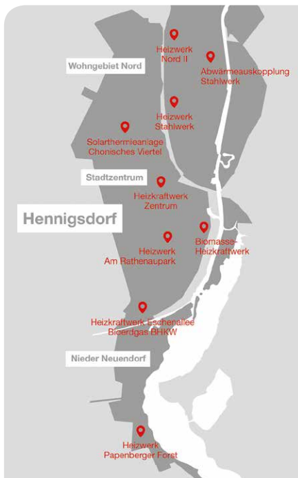
Sieben Heiz(kraft)werke speisen in das hydraulisch gekoppelte Wärmenetz
